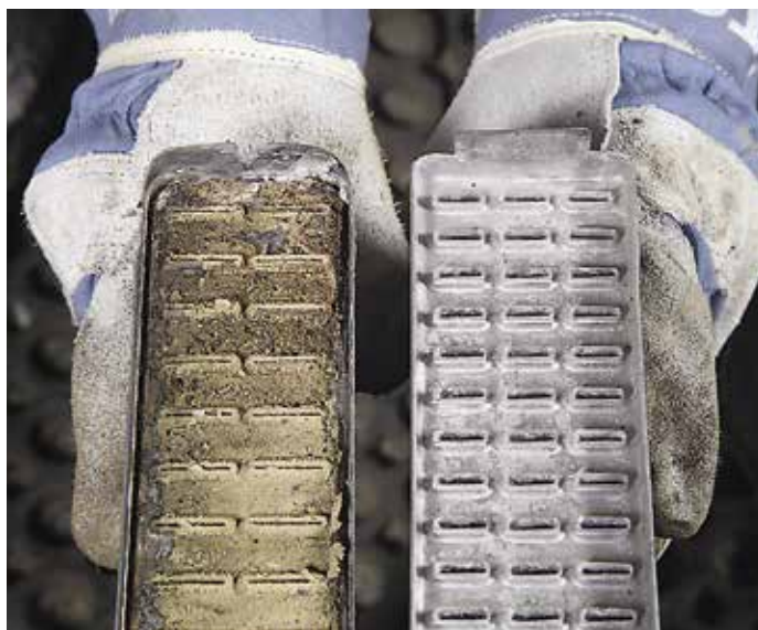
Auch bei guter Wartung neigen Kühlernetze zum Verkalken (links). Wenn es erneuert wird, ist ein Hochleistungsnetz (rechts) auf jeden Fall empfehlenswert
