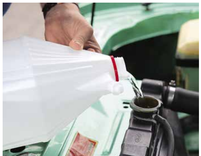
Weiches Regenwasser ist das ideale Kühlmittel. Ebenso wie destilliertes Wasser enthält es kaum Kalk und hat hervorragende Kühlleistungen
