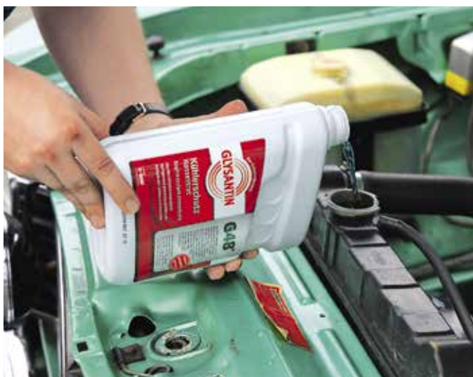
Silikalthiger Kühlerfrostschutz verhindert nicht nur das Einfrieren, er ist auch ein effektiver Korrosionsschutz und schließt leichte Undichtigkeiten
