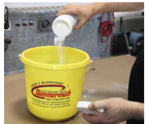
In die gleiche Menge heißen Wassers rührt Rüdiger Dommermuth das granulatförmige Entfettungsmittel ein
