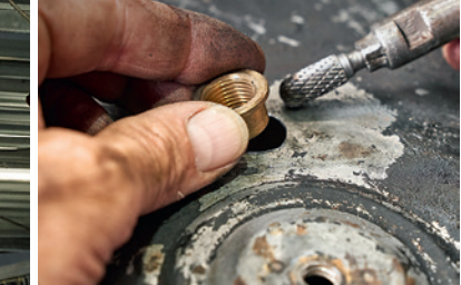
In die zuvor bereits auf Endmaß gefräste Bohrung kommt nun die...
