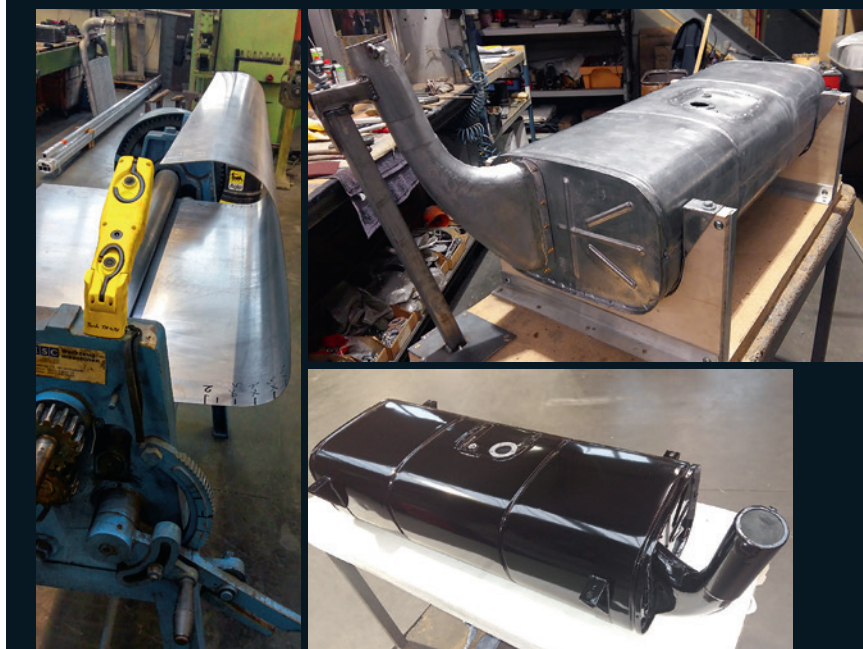
Der Mittelteil des Kraftstoffbehälters entstand aus Stahlblech komplett neu, Komponenten wie das Füllrohr wurden gemäß Vorbild genietet. Dank zuvor gefertigter Schablone (Bild oben rechts) passte der neue Tank auf Anhieb perfekt
