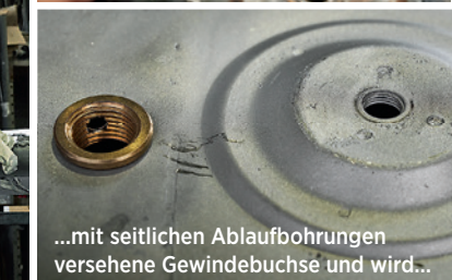
...mit Hartlot eingesetzt, das dank Silberanteil einen niedrigen Schmelzpunkt hat, was Verzug minimiert
