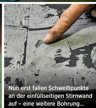
Durch intensive Inaugenscheinnahme und Abklopfen macht sich Roland Bockisch ein Bild vom inneren Aufbau des Tanks
