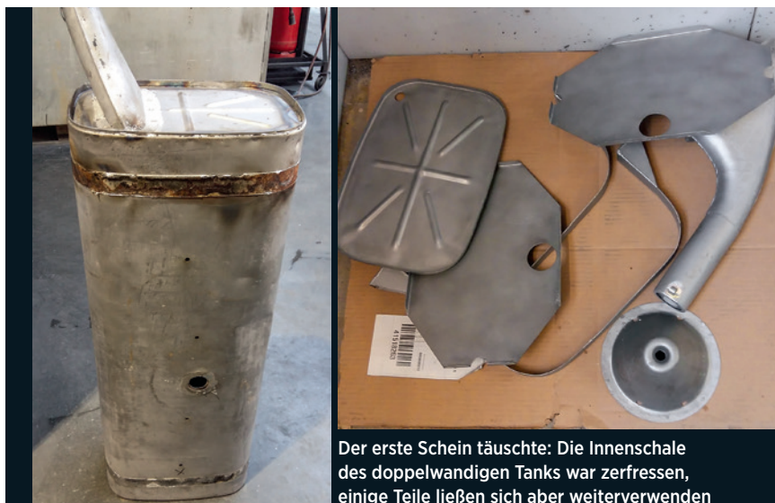
Vorsicht: Nur etwas zu viel Druck kann den Tank dauerhaft verformen!
